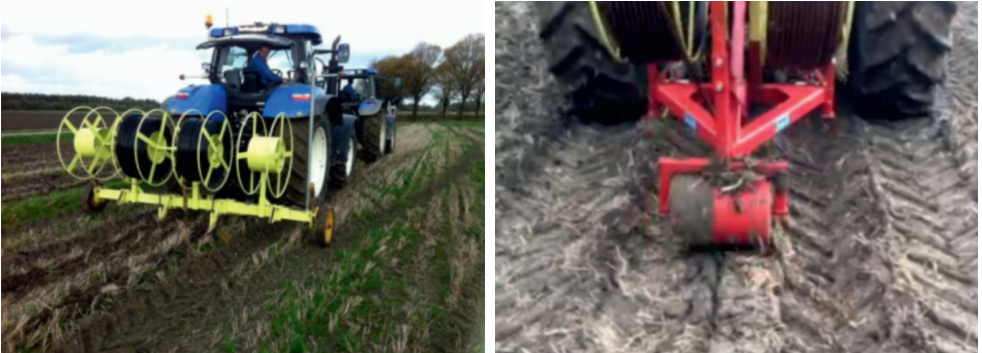
Afbeelding 3. Aanleg van het ondergronds druppelirrigatiesysteem in Borgsweer (2014).
