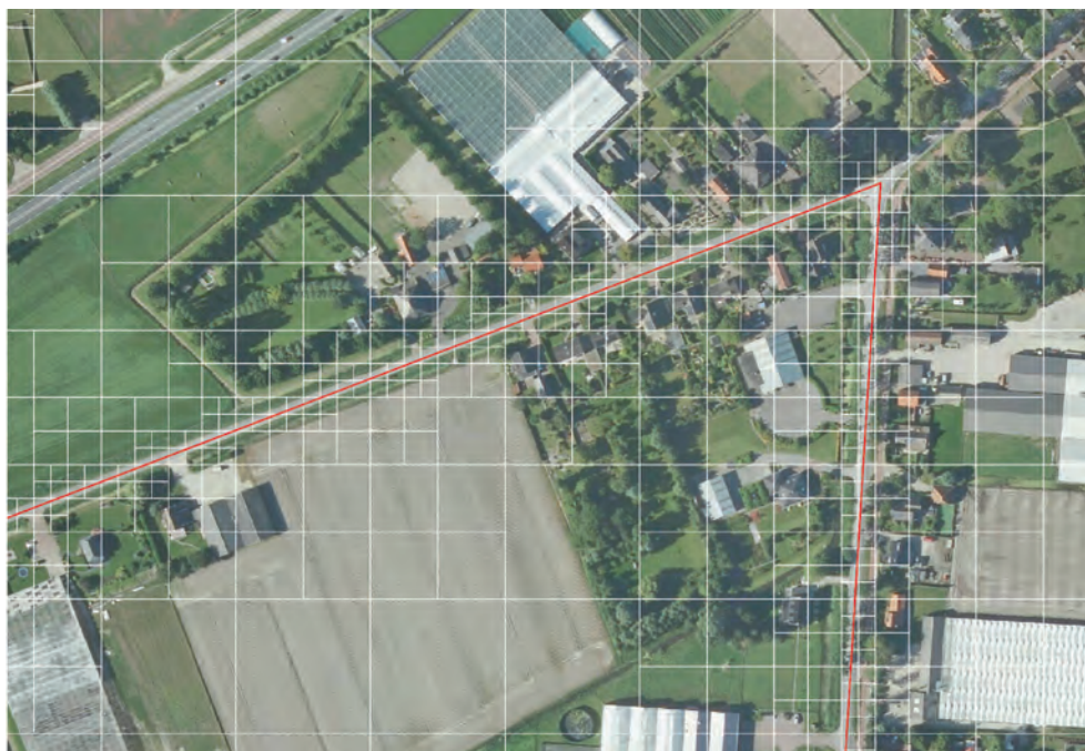
Afbeelding 2: Quadtree roosterverfijning bij een weg in combinatie met obstacles (rode lijn)
