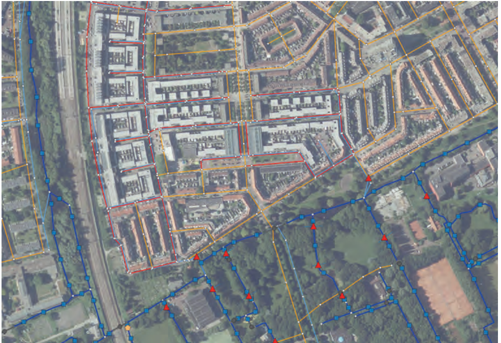
Afbeelding 4: 1D model met oppervlaktewater (donkerblauw), gemeente (geel), dwa (rood) en regenwater (lichtblauw) riolering. De rode driehoeken representeren de stuwen
