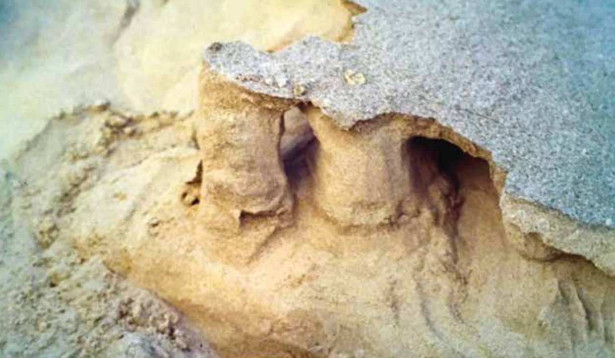
Afbeelding 9: Close-up van embryonale zandzuiltjes overwelfd door een coherent oppervlaktelaagje (naar Dekker en Ritsema, 1994)
